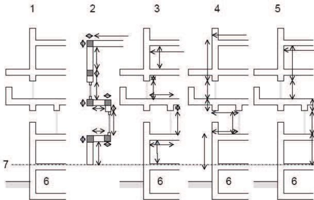
1 : réalité - 2 : éléments de construction - 3 : dimensions intérieures - 4 : dimensions extérieures
