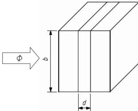
$\Phi$  : direction du flux thermique
