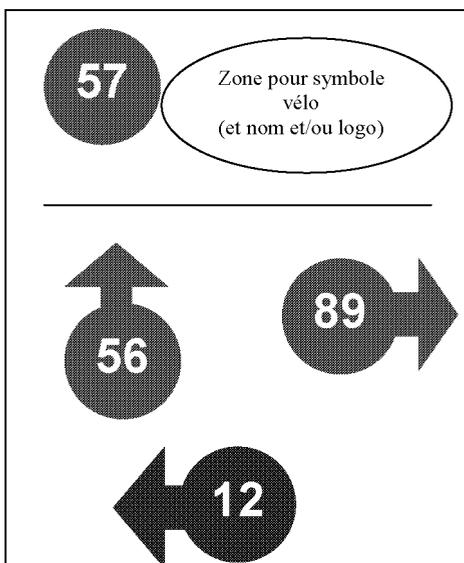
Les dimensions maximales de la balise directionnelle complète sont les suivantes : largeur 400 mm - hauteur 600 mm.
